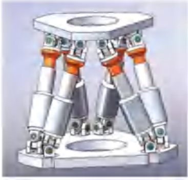
图1 Stewart平台结构示意图
